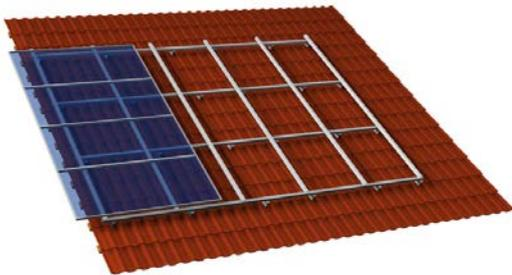
Per montare i pannelli senza cornice è necessario un sistema a guide incrociate. Il telaio così realizzato è particolarmente stabile. Si prega di osservare le istruzioni di montaggio del produttore dei pannelli fotovoltaici.
