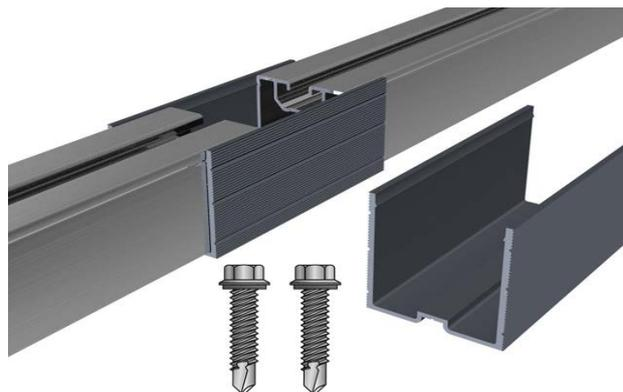
Inserire l'elemento di giunzione sul primo profilato e fissarlo nella scanalatura fino allo scatto. Successivamente fissare il secondo fino allo scatto e unirli al precedente, facendo pressione. Avvitare con due viti perforanti per fissare il tutto. (Coppia di serraggio: 8 - 10 Nm)
