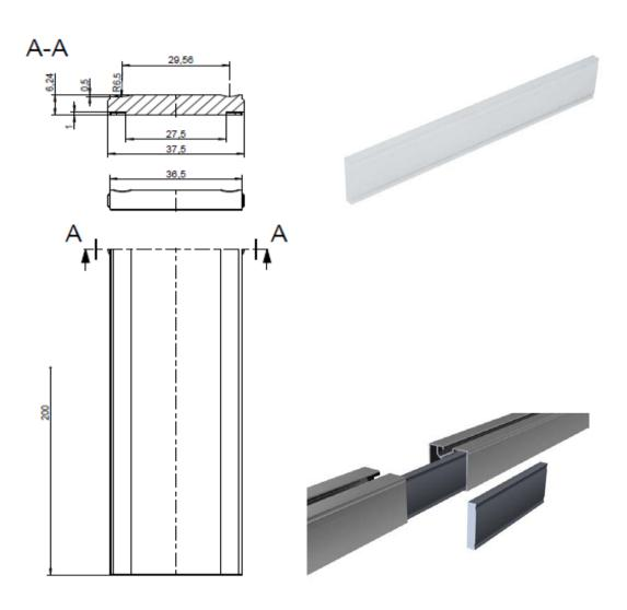
La piastra di giunzione (W 18) viene inserita nel profilato solo fino a metà. Successivamente spingere l'altro profilato sulla piastra e unire tra loro i due profilati, facendo pressione. Half of the connector (W 18) is pushed into the mounting rail. Then push the other mounting rail onto the connector. Afterwards, you push together the mounting rails with pressures.
